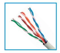
**Cable U/UTP categoría 5e CM**, resistente a la propagación del fuego, de cobre sólido calibre 24AWG, diseñado para cableado horizontal transmitiendo, voz, datos y video, con un ancho de banda de 100Mhz, ampliamente utilizado para aplicaciones de video vigilancia análogo. Cada caja contiene 305 m (1000 pies)
