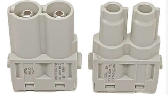
HMK70-002.1-M/F 70A/1000V/螺丝接线 占用1个模块位
