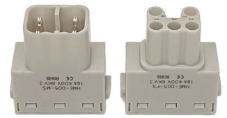
HME-005-MS/FS 16A/400V/冷压/弹片 占用1个模块位
