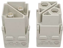
H2MK-002.1-M/F 100A/1000V/螺丝接线 占用2个模块位
