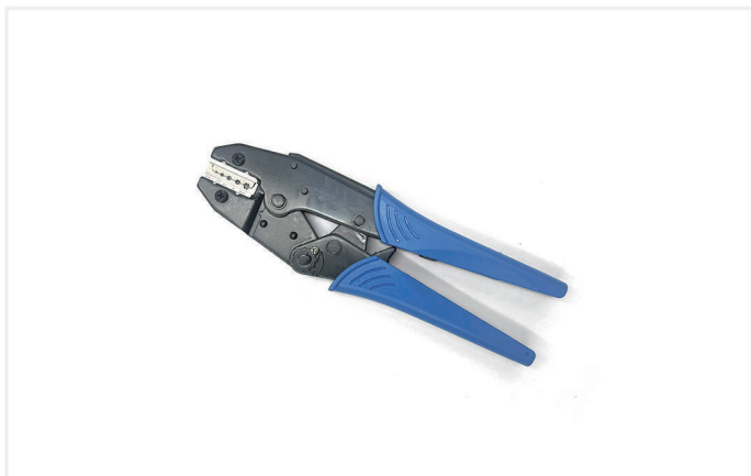
压线钳(线规: 0.14~6mm 2 ) 适用5A/10A/16A/40A 接插针
